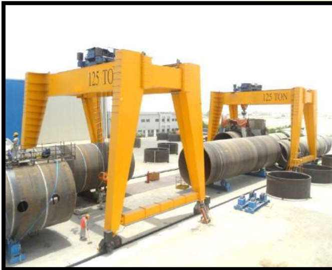
125 Ton x 2 nos Goliath Crane
